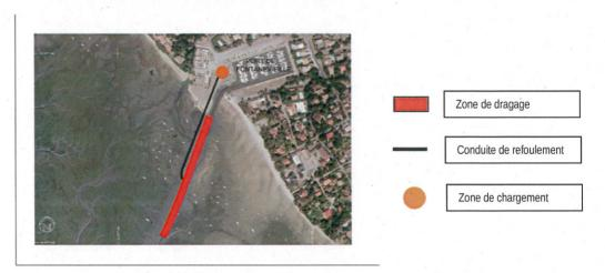
Ces travaux nécessitent l'intervention d'un engin sur ponton flottant, et d'une conduite de refoulement pour acheminer les sédiments jusqu'au quai. La conduite de refoulement sera flottante et matérialisée par des bouées.
