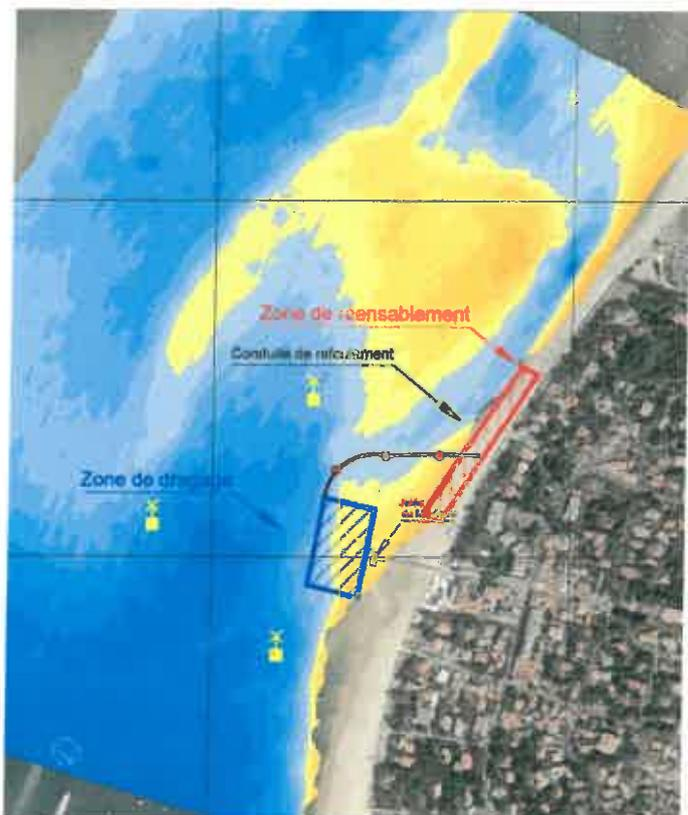
L'installation sera balisée par 3 croix de St André situées de part et d'autre de la drague : au nord et au sud et une à l'ouest. Celles-ci seront déplacées au fur et à mesure de l'avancement du chantier. La conduite de refoulement sera signalée par des bouées rouges espacées d'environ 30m.
