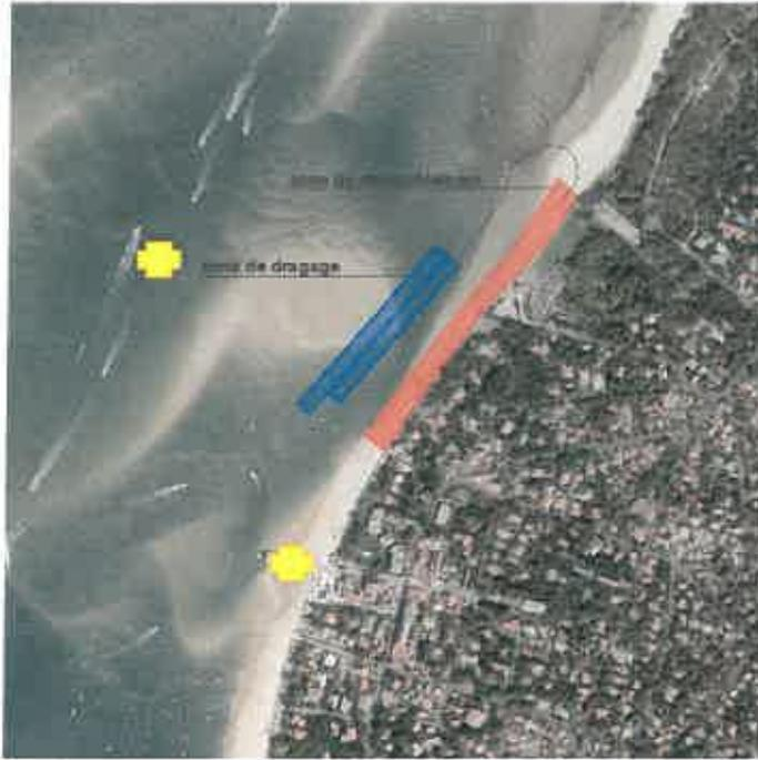
L'installation sera balisée par 2 croix de St André situées de part et d'autre de la drague : une au sud et une à l'ouest. Celles-ci seront déplacées au fur et à mesure de l'avancement du chantier.
